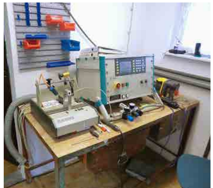
Här balanseras motorerna till en nivå 10ggr bättre än en normal modellturbin
