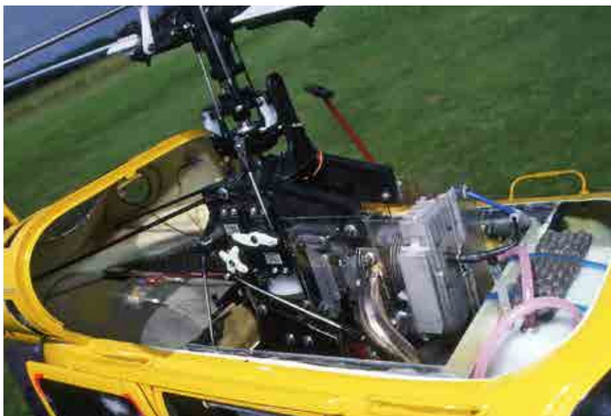
Motorn sitter högt upp, just under rotorhuvudet.
