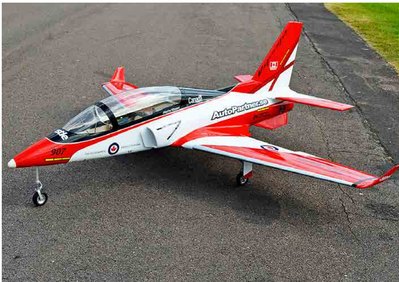
Nytt inom modellflyget, Viper Mk II med eldriven fläkt, i stället för en jetmotor.
