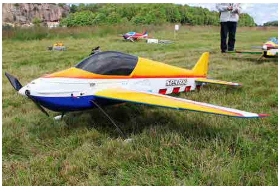
Spark med sågtandad framkant. Modellen är helt gjord i komposit.
