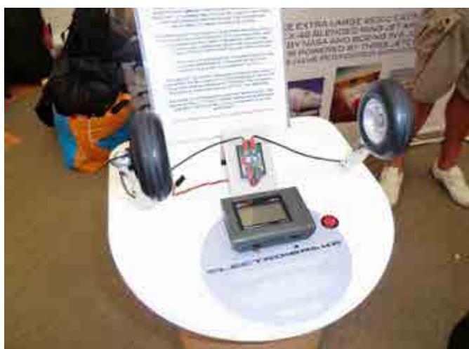
GBR-Jets mycket fiffiga elektriska ABS bromssystem.
