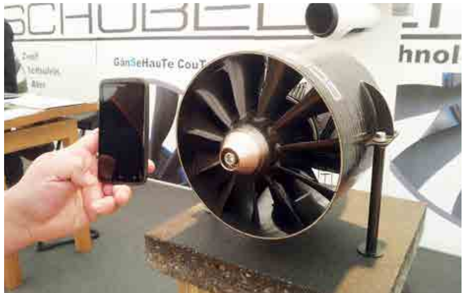
Schubeler DS-215-DIA HST, 195mm EDF på 25kg dragkraft.
