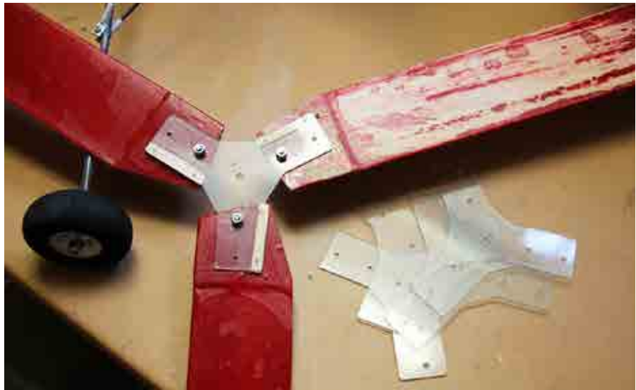
En liten balsakloss i bakkant för den där mystiska något negativa anfallsvinkeln och några oanvända rotorskivor. Klossen underlättar autorotationen och för att rotorn inte ska ställa så lätt.
