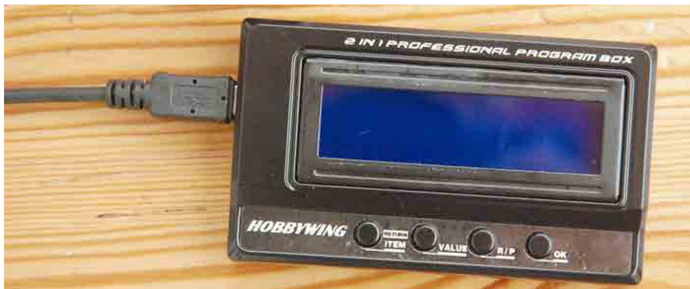
Till fartreglage Hobbywing Platinum 120 A HV Pro Opto hör HW Advanced PRO Program Box.
