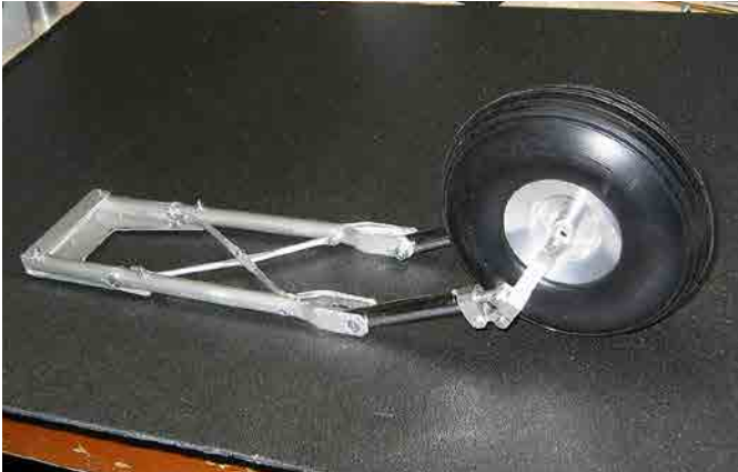
Landningsställ till DC-3 av aluminiumsmide.
