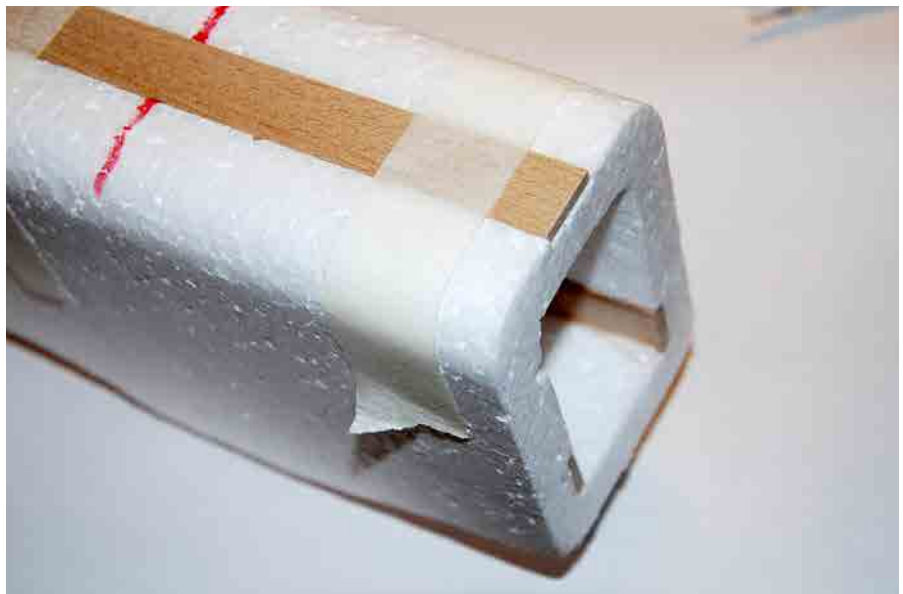
Framkroppen med perfekt formade skåror för förstärkningarna i form av balsalist.
