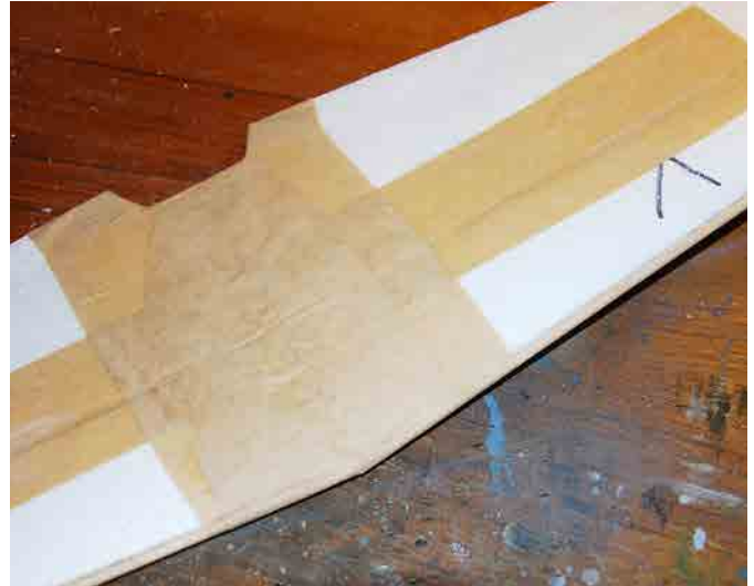
Vingen förstärks först med remsor av brunpapp innan hela vingen kläs med brunpapp. Man kan med fördel förstärka vingmitten med s.k. målarremsa också.
