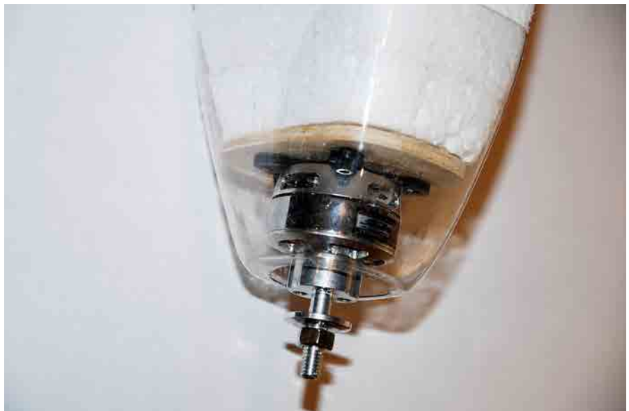
Motorinstallation innanför motorkåpan av PET-plast.
