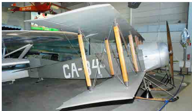
Detta Caudron C60 från 1921 försett med en 130 hästars Clerget-motor är ett skolplan som var i aktivt bruk fram till 1936.
