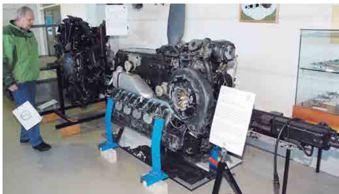
En Daimler Benz 1475 hästars motor avsedd för Messerschmitt BF 109.
