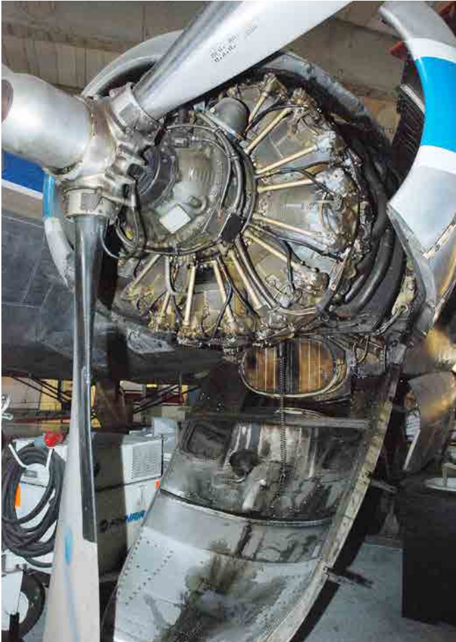
Metropolitanmotorn är en dubbel Wasp på 2800 hästar.
