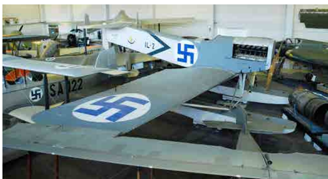
I.L.V. A22 Hansa från 1922 är ett tresitsigt licensbyggt sjöspansningsplan. Just detta plan är det äldsta bevarade flygplanet byggt i landet.
