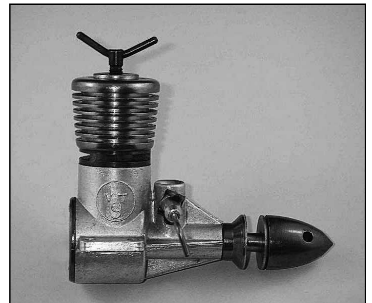
V.T. 9 1,5 cc diesel från 1959. Här nedan V.T. 0,25cc i två olika utföranden. Som jämförelse - till vänster - en Allbon Bambi.
