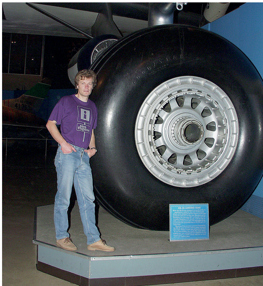
Det här enorma hjulet är från en B-36. Hjulet är visserligen stort men så vägde ett fullastat plan hela 186 ton. För att fördela den enorma tyngden bättre ersattes so-lohjulet senare av fyra mindre.
