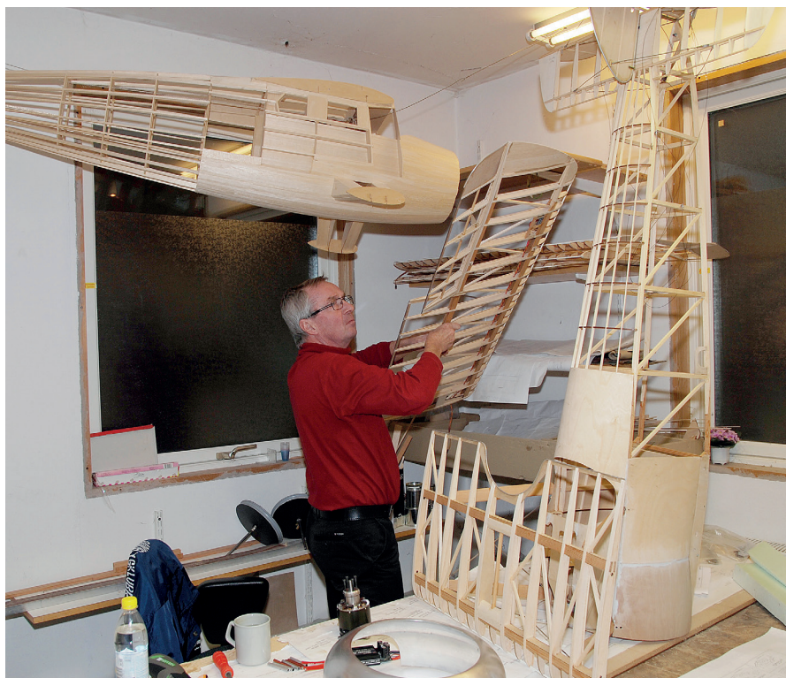
I Andes Ödéhns bygghörna hittar vi en saftigt stor Noorduyn Norseman och en Sopwith Camel i 1/3-delsskala. Camel:en är en Mick Reeves byggsats Anders har jobbat på i två säsonger. Motorn till den är en Turnigy CA80, vilket motsvarar en bensinmotor på 80 cc. Anders kommer att köra med 44 Volt och cirka 100 Amp, alltså motsvarande 4,4 kw = 6 hk.
