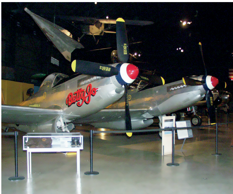
Betty Jo – dubbel Mustang. Det ser ut som två vanliga Mustangkroppar satts på en vinge men det rör sig om en nykonstruktion. De dubbla Packard V12:orna på vardera 1380 hästar fick upp kärran i 450 knyck.
