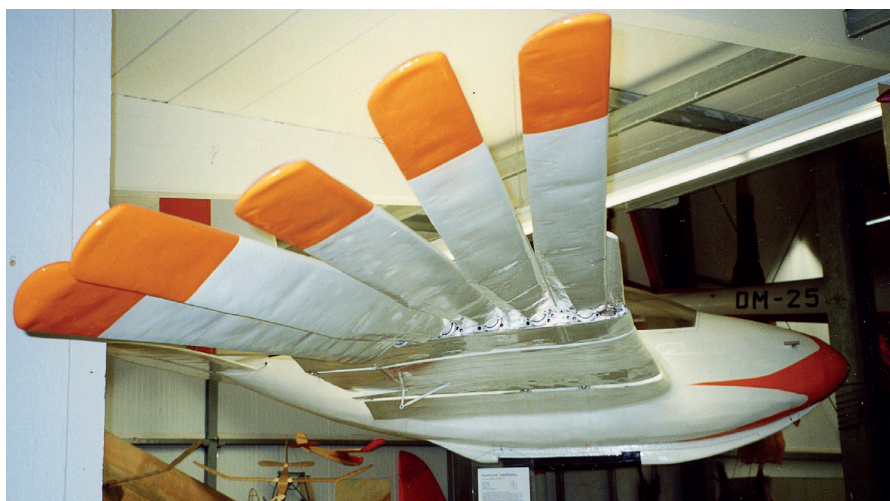
Vingtipparna på ett segelflygplan. Detta experiment försökte efterlikna fåglarnas effektiva vingpennor.
