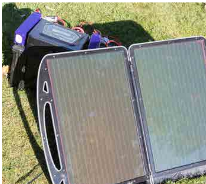
Solceller som laddar ett bilbatteri, som i sin tur via laddare laddar en drivack. Daniel Bergqvist visar hur det kommer att se ut på våra miljövänliga modellflygfält i framtiden!
