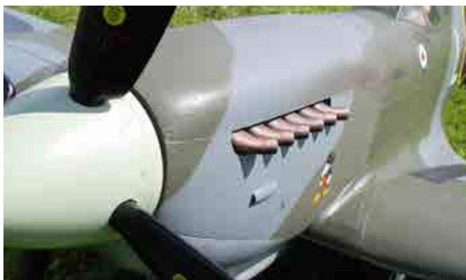
Stefans modell är i skala 1:5,3 och har därmed 2,10 meter mellan vingpetsarna. Den cirka 8 kilo tunga Spitfiremodellen drivs av en engelsk Laser-motor.
