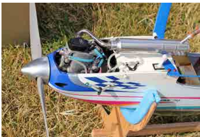
YS 180 med kompressor, bränslepump och elektronisk tändning. En mycket vacker motor, ett tekniskt mirakel och enligt min uppfattning en relik i F3A sammanhang.
