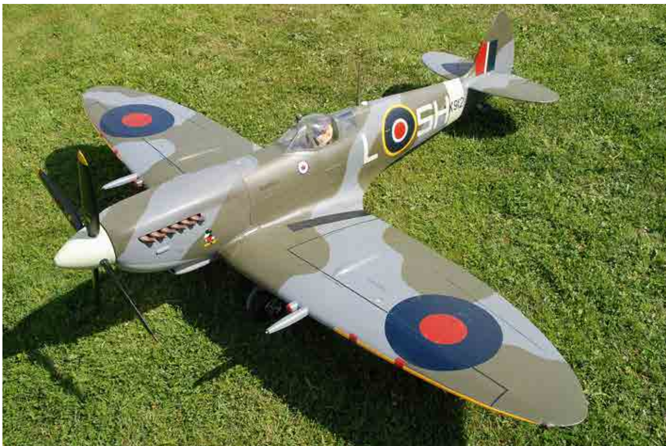
Stefans modell är byggd helt och hållet av lösvirke efter en Brian Taylor-ritning. Hela modellen är av balsa som täckts med tunn glasfiberduk innan målning.
