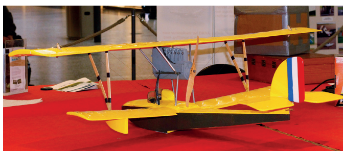
Flygbåten Macchi M5 är en skalakärra från första världskriget. En jaktflygbåt från Italien som fanns ett par i England. Macchi M5 byggdes i 350 exemplar. Den var mycket snabb för den tiden och utrustad med två kulsprutor i nosen. Spännvidd 140cm, borstlös elmotor, ack 3 celler om 2200mA. Modellen var försedd med motor, sida, höjd, skevroder. Kärran flyger bra men är lite jobbig att bygga.
