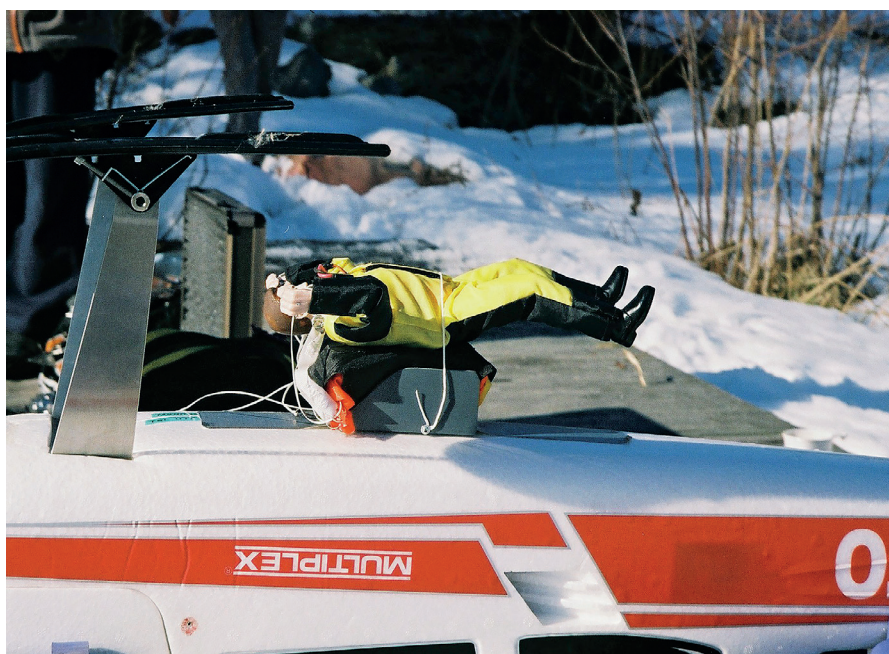
Hopparen med packad skärm monterad under hopp-planet. Observera att planet är lagt upp och ner för att lättare se och monterar hopparen.
