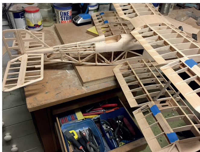
Vackrare än så här blir det inte! En SE5a i fackverkskonstruktion, färdig för klädsel.
