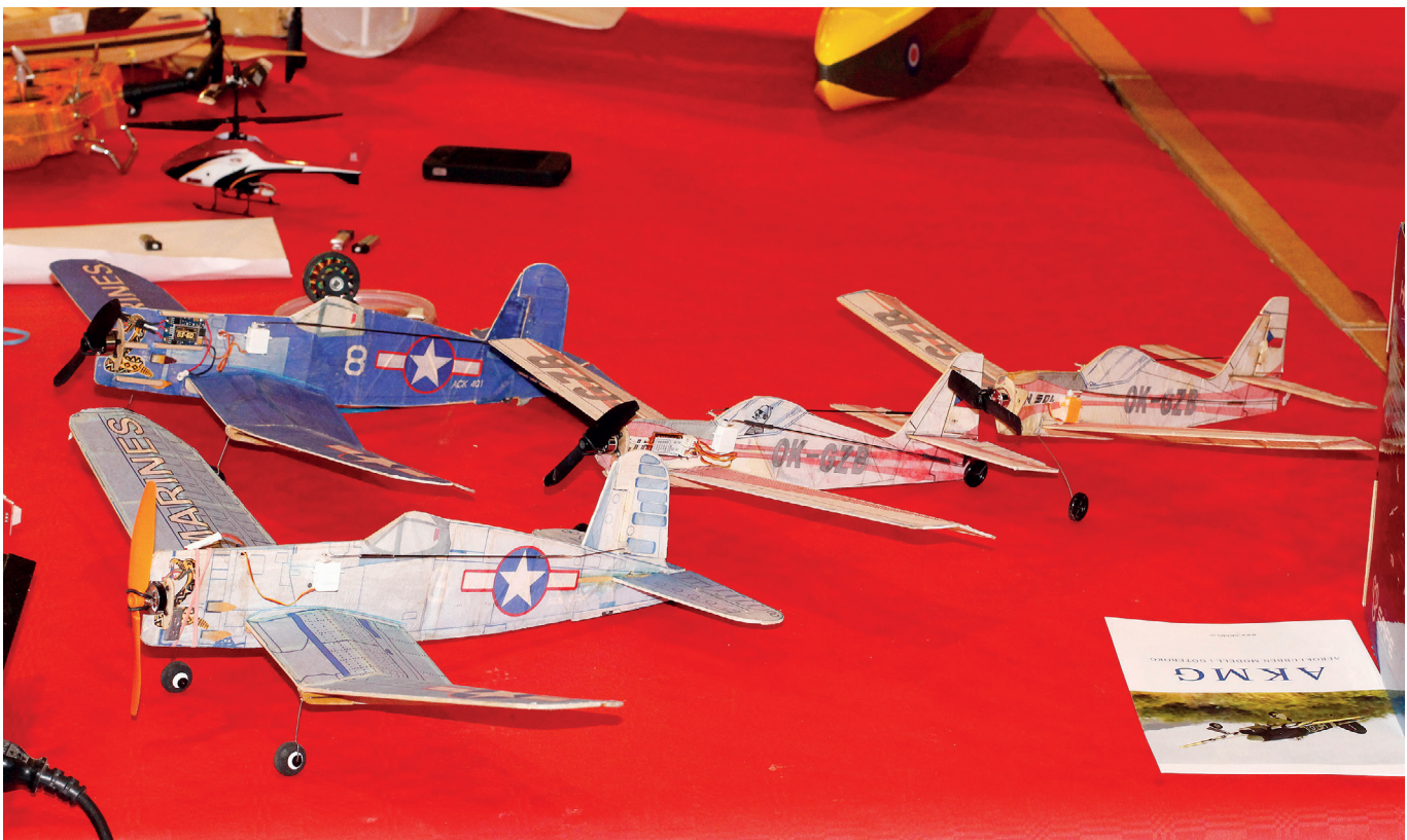
Zlin och Corsair baserade på Rune J ACKUS gummimotorbyggsatser försedda med små borslösa motorer en cell 3.7V ack 160mA. Motor, sida och höjdroder. Flyger bra inne som ute.
