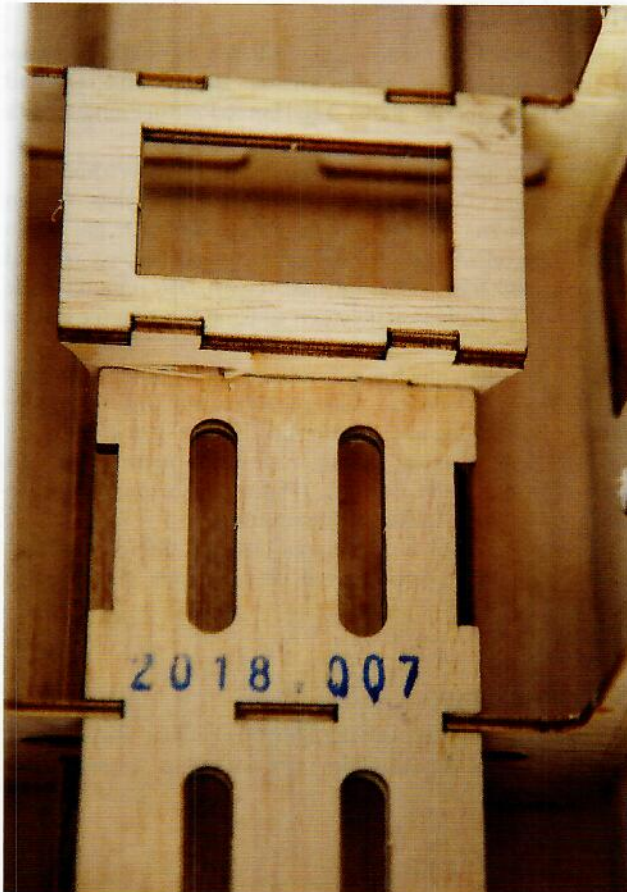
Motor servots fäste måste tas bort för att få tyngdpunkten på 165 mm från framkant vid eldrift.
