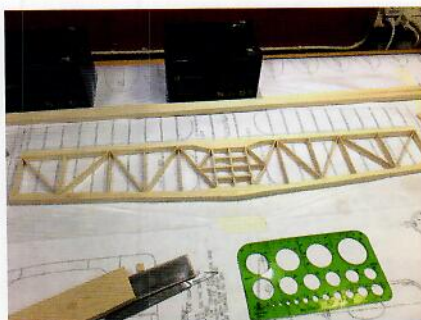
Stabbe och roder byggdes upp med fackverk och helpankades med 1,5mm balsa.
