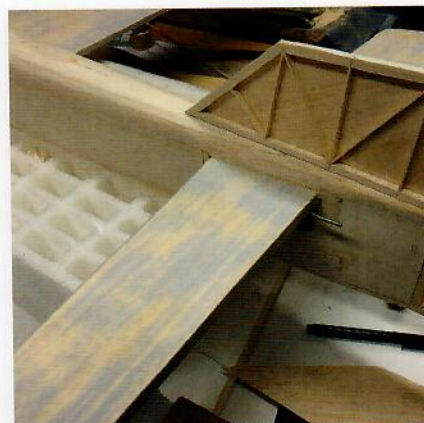
Passformen mot kroppen testas här innan fenan får sin andra plankning. Fenan limmades utan utåtriktning och saknar sidroder.
