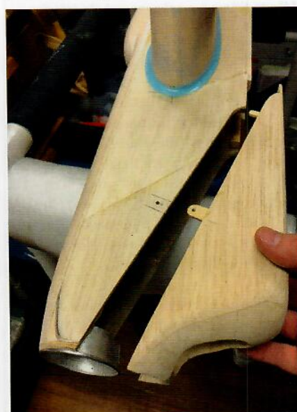
Ovandelen av en rund kakform limmades i nosen. En liten luftspalt mellan kakformen och spinnern bidrar till värdefull kylning av motorn. Vingrotsutfyllnaden gjordes med Super Fil från Brodak
