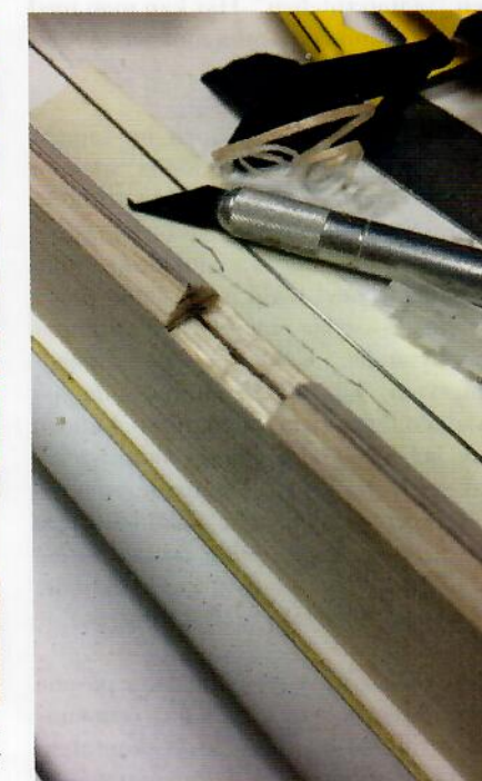
Detaljbilder av hur rodren har gjorts löstagbara. En pianotråd går i en kanal i rodrens framkant igenom alla gångjärnen.
