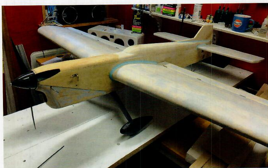
När modellen var träfärdig började ytbehandlingen som bestod av Hagmans Stålplast och Radolph Butyrate dope (klarlack och färger).
