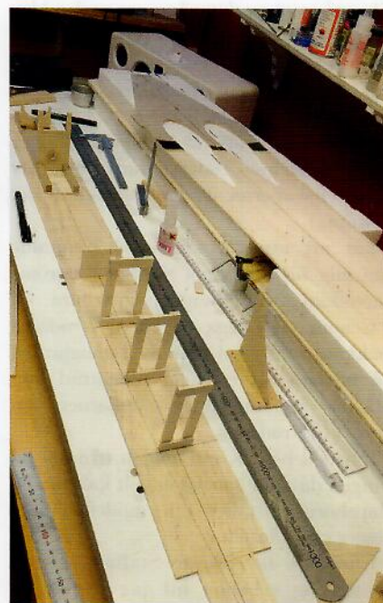
Här är motorbockspaketet och spanten limmade mot balsaflaket. De är alla limmade mitt på centrumlinjen så noga som möjligt.
