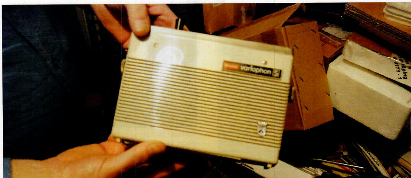
En Graupner Variophon. Detta var en radio chassi från Grundig. Tittar man noga så ser man högtalaruttaget i gallret för vanlig radiomottagning att lyssna på P3
