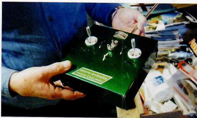
En Micro-Avionics med spakar i metall som byggdes på en annan teknik när det gäller spakar. Alla rörelse gick i kugghjul i metalhölje och trimmarna flyttade hela mekaniken.
