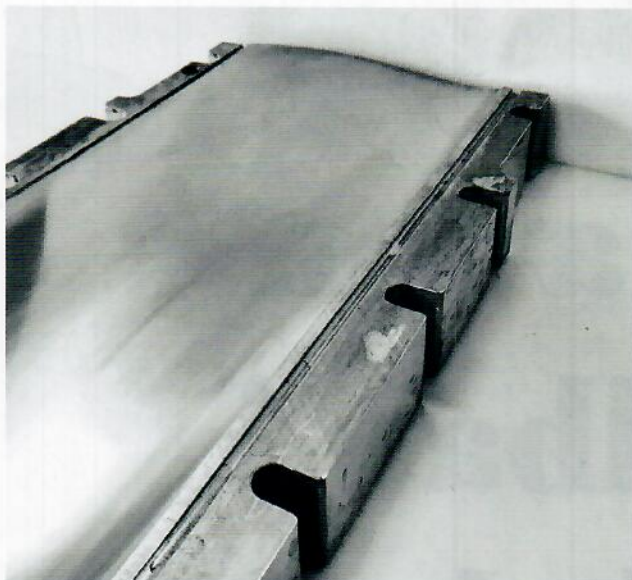
En kort bit av aluminiumformen till en F1A-vinge, undersidan.
