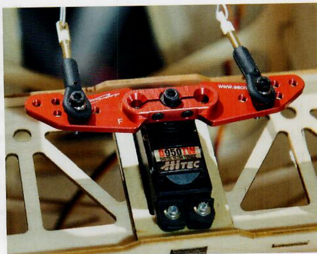
Jag valde Secraft servook till alla servon, jag trodde först att jag skulle behöva ett excentriskt ok till sidrodret, men märkte senare att det inte behövdes. Jag fick flytta in ankringspunkten mot centrum för att inte få för stora utslag.
