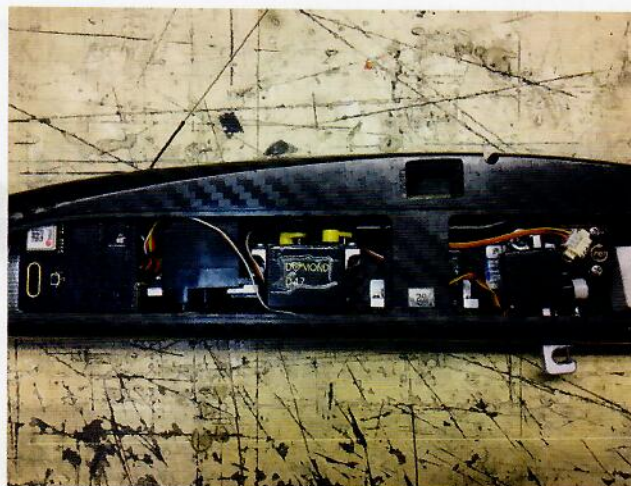
Delarna på plats i Nosen på en LDA-flapper, timer, stab servo, två flaps servon, roderservo och krok..
