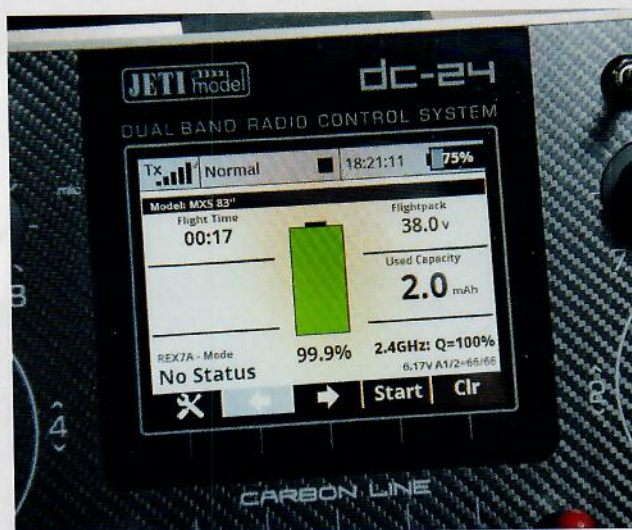
Jag fick en fin display programmerad i Lua av Mattias Hemborg, grafiken av batteriet är animerad och den gröna stapeln blir lägre när batteriet används och vid 30% av batteriets kapacitet blir batteristapeln röd.
