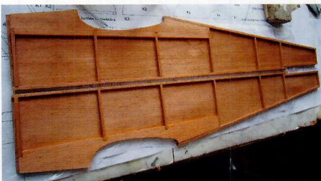
De betsade kroppssidorna tillskurna med förstärkningar och vingsadel
