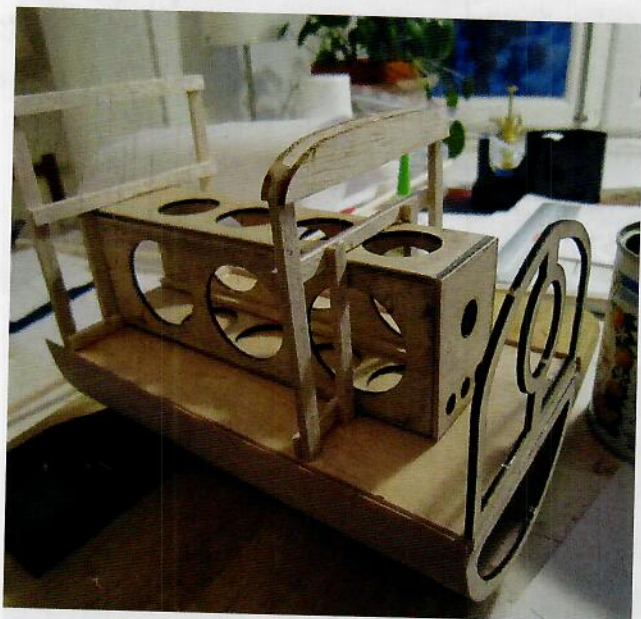
Här syns hur delarna till nosen (som ligger upp och ner) är monterade.
