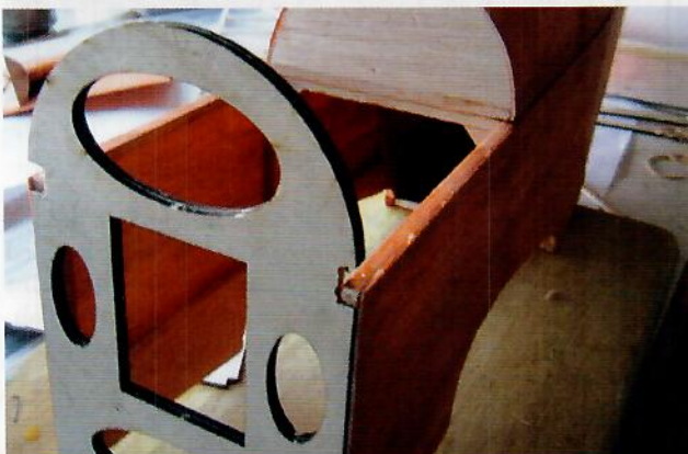
Kroppssidorna ihopfogade och motorspanetet på plats
