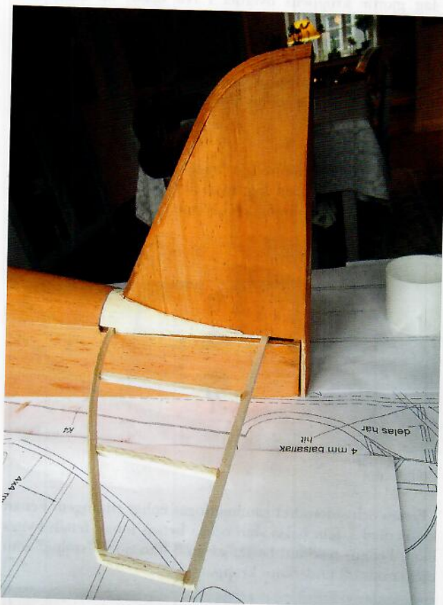
Fenan monteras ovanpå stabilisatorn
