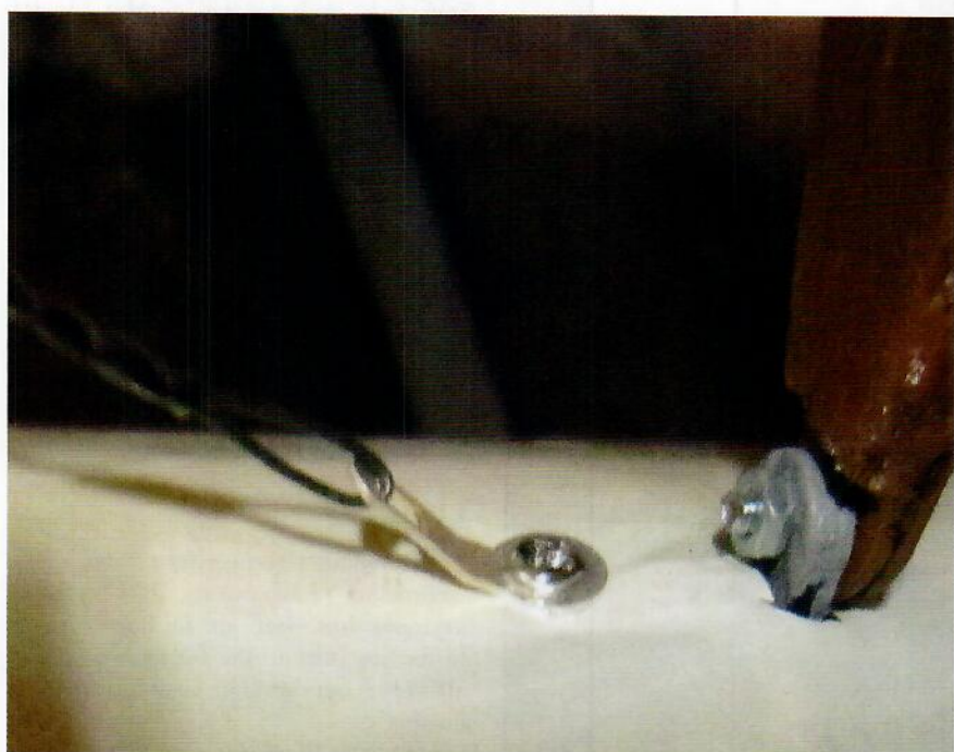
Lödöra kan användas för att fästa riggtråd
