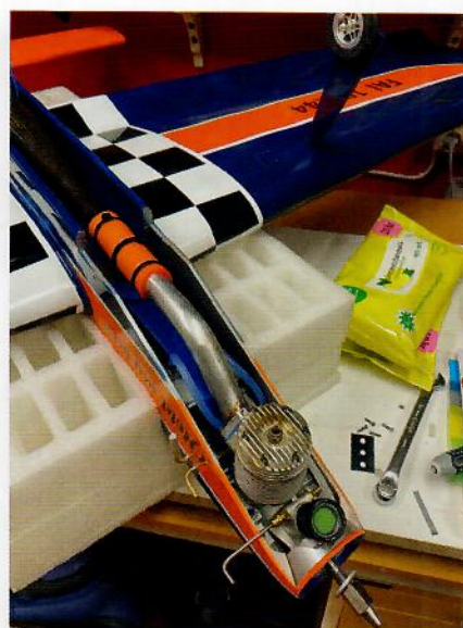
Med motorkåpan avtagen kommer man lätt åt motor, pipa och tank.
