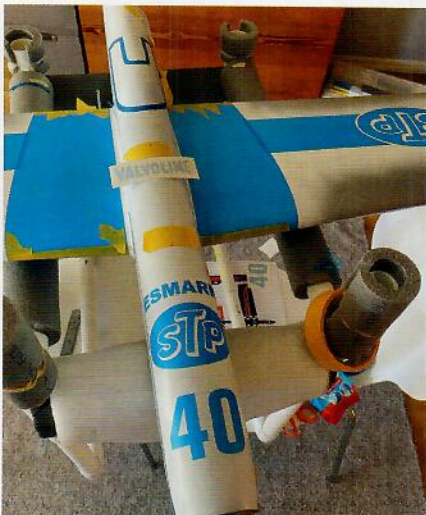
Grafiken på modellen sprejmålades med hjälp av vinylmallar. Mallarna skapades i programmet Adobe Illustrator.
