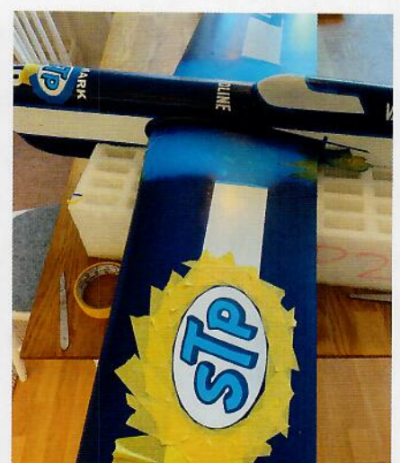
Grafiken på modellen sprejmålades med hjälp av vinylmallar. Mallarna skapades i programmet Adobe Illustrator.
