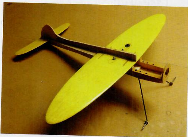
Modellen har en balsavinge med bärande profil. Kroppen byggs upp av en 10 mm platta och stående bitar på över- respektive undersida. Vingen kan man klä med siden eller japanpapper.
