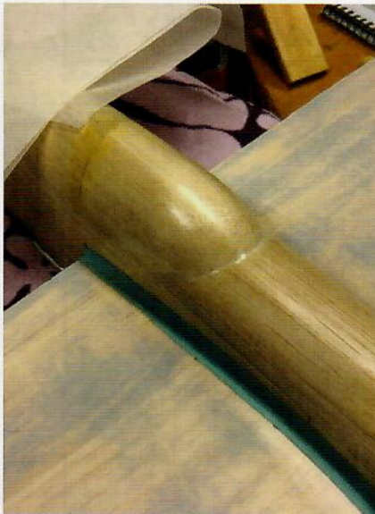
Modellen kläddes med silkspan och lackades med Randolph dope.
