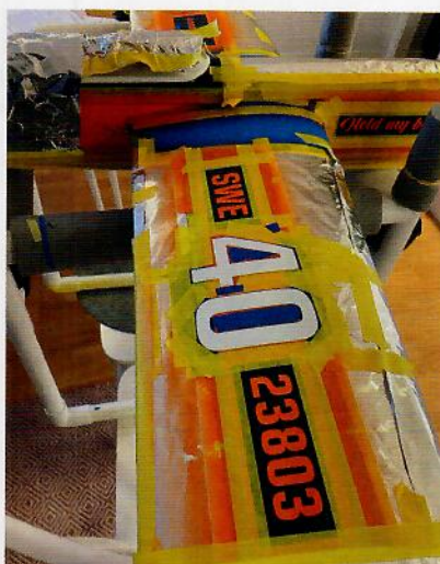
Grafiken på modellen sprejmålades med hjälp av vinylmallar. Mallarna skapades i programmet Adobe Illustrator.
