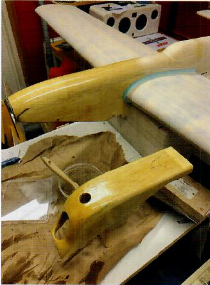
Nosen och motorkåpan får ett par lager glasfiberväv.
