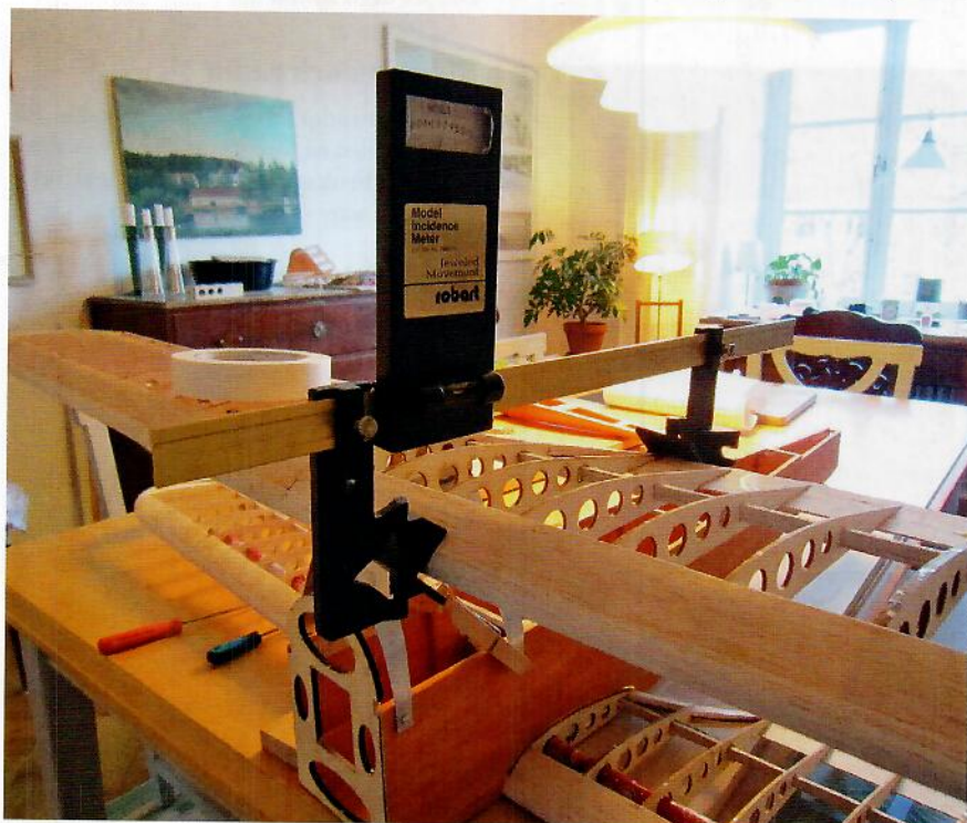
Inpassning av vingarna. En vinkelmätare från Robart underlättar
