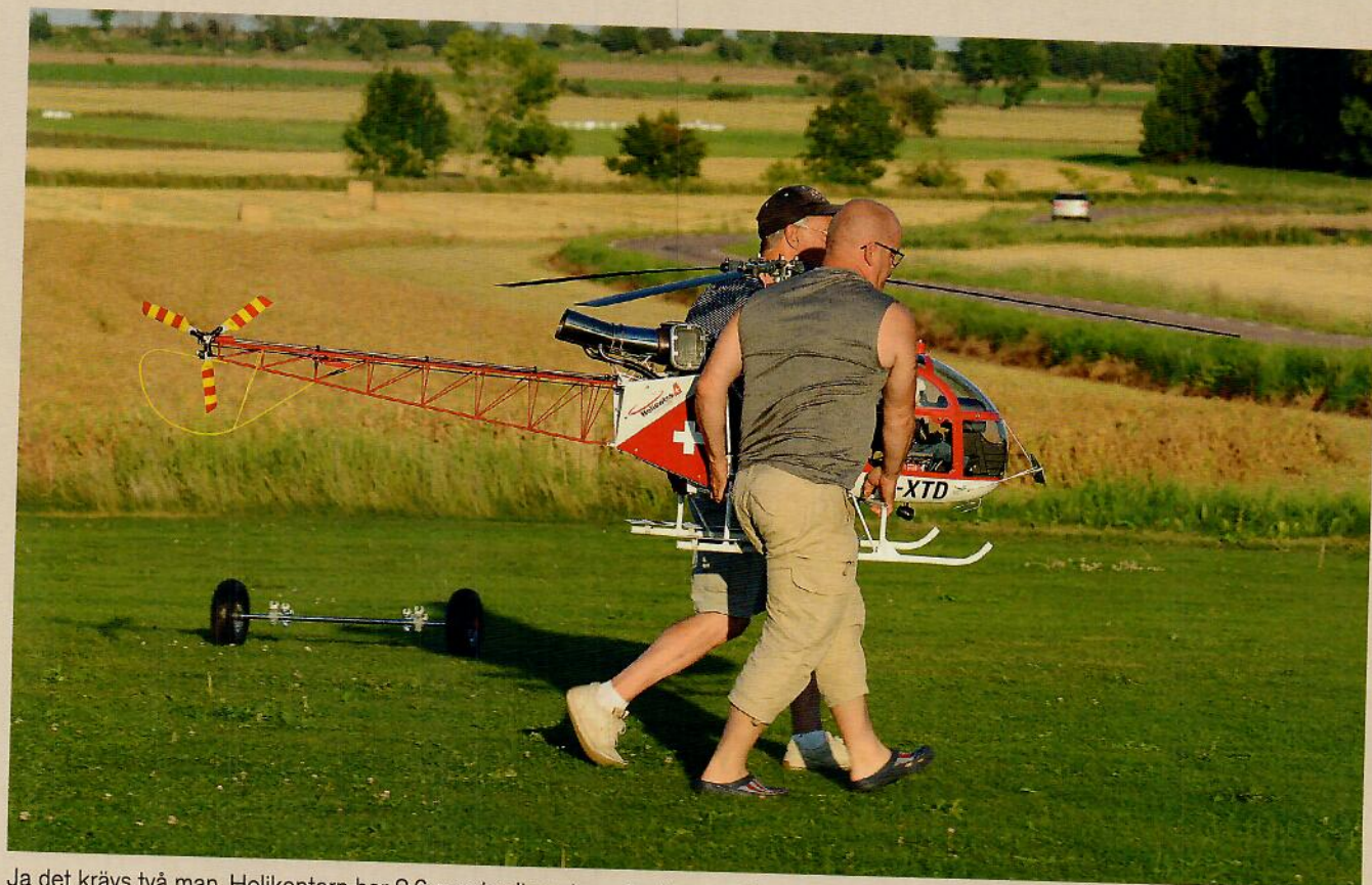
Ja det krävs två man. Helikoptern har 2,6 m rotordiameter och väger ca 23 kg.
