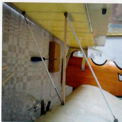
Plaströr och pianotråds-vinklar användes för att göra mallar till de slutgiltiga stöttorna
