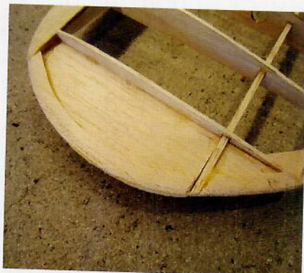
Vingspetsarna kan förstärkas med balsa på översidan
