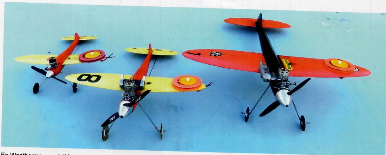
En Weatherman-modell kan byggas i tre storlekar. Den i mitten är originalstorleken och används i klass 1 till 5 (dvs från Mills 1,3 cc till 5 cc). Modellen på bilden tävlar i klass 4G och har en K&B 3,5 cc i nosen. Modellen till vänster har en MP Jet 1 cc diesel och tävlar i klass 0D. Här får modellen vara 25% mindre än originalet. Slutligen har vi klass 6 och 7 där modellen får vara en faktor 1,414 större. Modellen till höger på bilden tävlar i klass 6G och har en HP 40.
