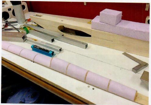
Gjutformen tillverkades av 3 mm plywood och styrofoam. Den limmades sedan mot en 4-kantbalk av aluminium för extra stabilitet.
