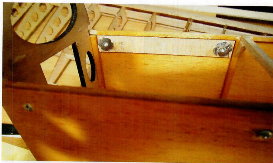
Förstärkning för montering av vingpylon.
